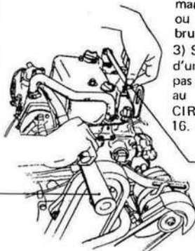
Decompression lever Levier de décompression
